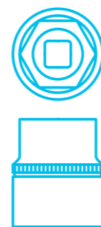
Nasadka sześciokątna (napęd 1/4" 13 mm)
